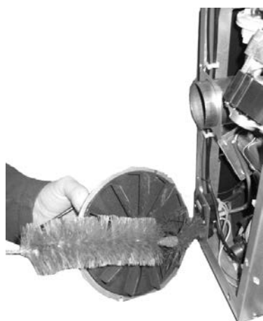
Fig. 98 - Czyszczenie odciagu dymu: faza 1
