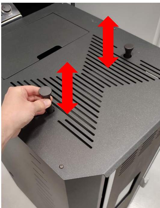
Czyszczenie zawirowywaczy spalin
