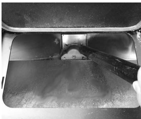
Fig. 22 - Czyszczenie zbiornika i ślimaka
