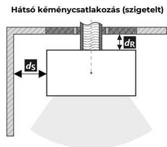
A füstcső áthaladása éghető anyagból készült falon
