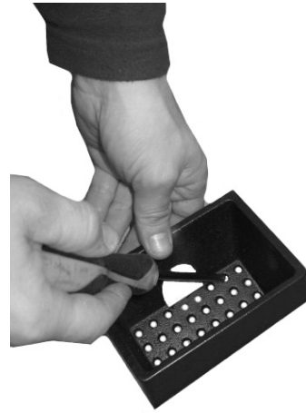
Fig. 32 - Czyszczenie rusztu paleniskowego
